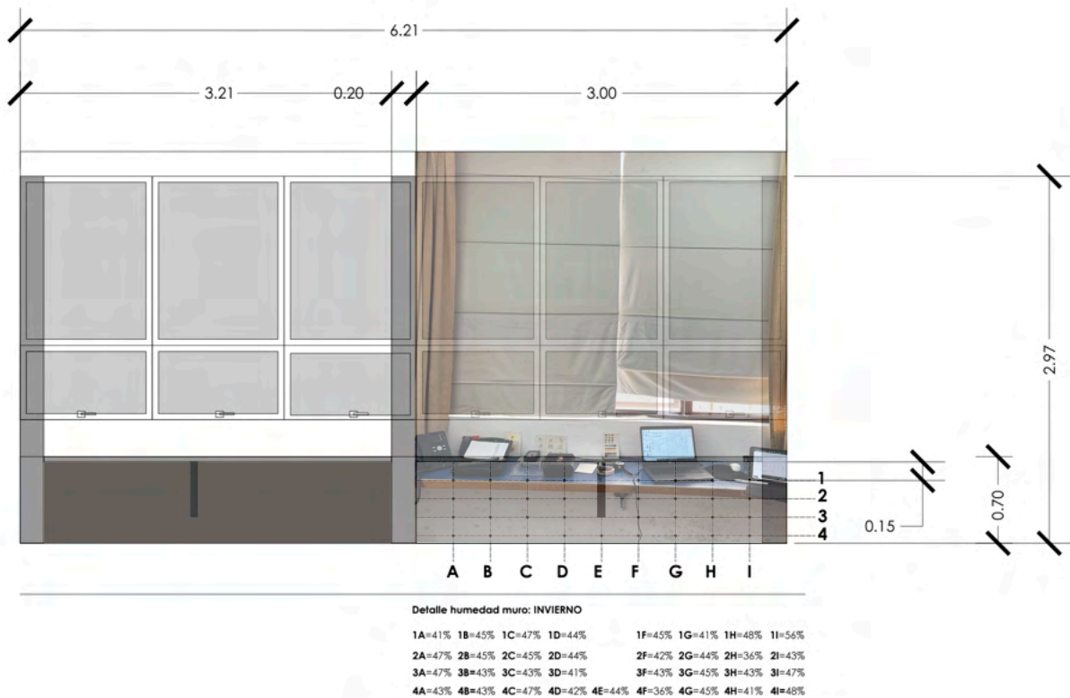
Figura 79 Mediciones puntuales de HR% en Muro de depósito/oficina, Archivo MW
