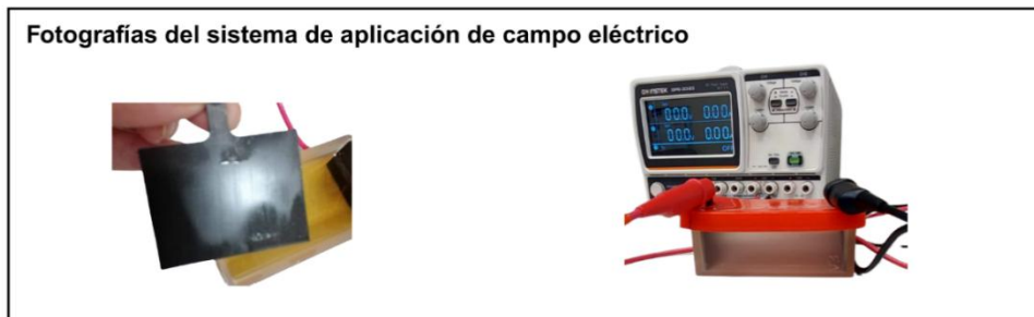
Figura 20. Fotografías de electrodos y sistema de aplicación de campo eléctrico real. A la izquierda se observa un electrodo de grafito utilizado en la microcámara de cultivo, mientras que a la derecha se muestra la conexión de la cámara a la fuente de poder de corriente continua empleada para aplicar los potenciales eléctricos durante la biosíntesis de CB.
