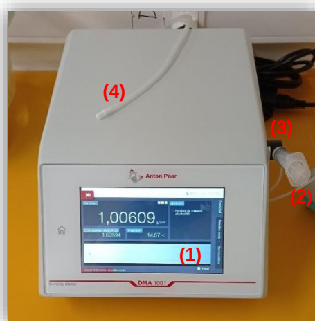
Figura 3.3. Densímetro digital usado para las mediciones. (1) Pantalla táctil; (2) Jeringa; (3) Adaptador Luer 1/4"; (4) Manguera de la bomba de aire.
