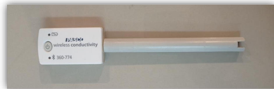
Figura 3.6. Conductímetro de placas paralelas usado para las mediciones en muestras de solución
