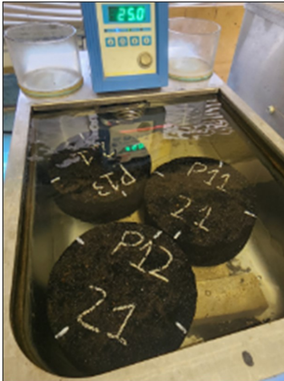
Figura 27: Acondicionamiento en Condición Saturada para CMA.
