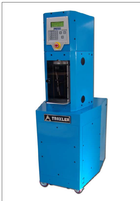
Figura 29: Compactador Giratorio Superpave Utilizado en la Investigación.
