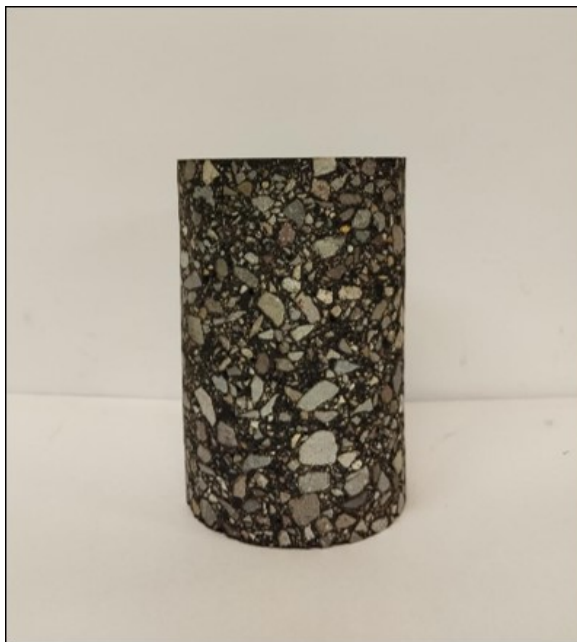
Figura 49: Probeta Posterior a Ensayo de Módulo Dinámico.
