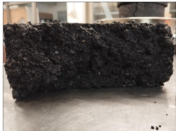
Figura 48: Probeta Ensayo de Tracción Indirecta en Condición Saturada.
