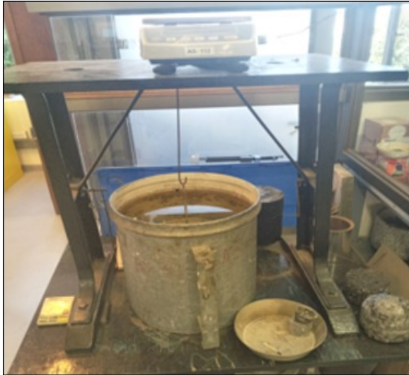
Figura 34: Balanza Electrónica para Ensayos con Probeta Bajo Agua.
