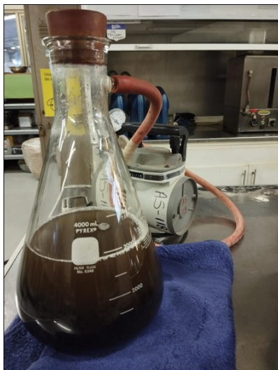
Figura 32: Bomba Operando para Ensayo de Densidad Máxima Suelta.
