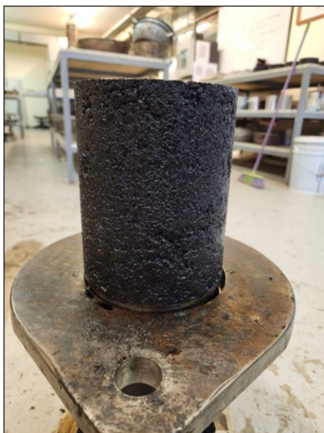
Figura 42: Probeta Completa para Ensayos de Módulo Dinámico y Número de Flujo.
