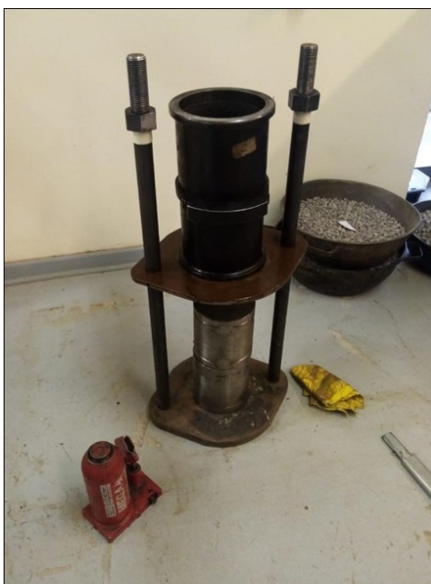
Figura 30: Molde Compactador Giratorio Superpave sobre Extrusor de Probeta.
