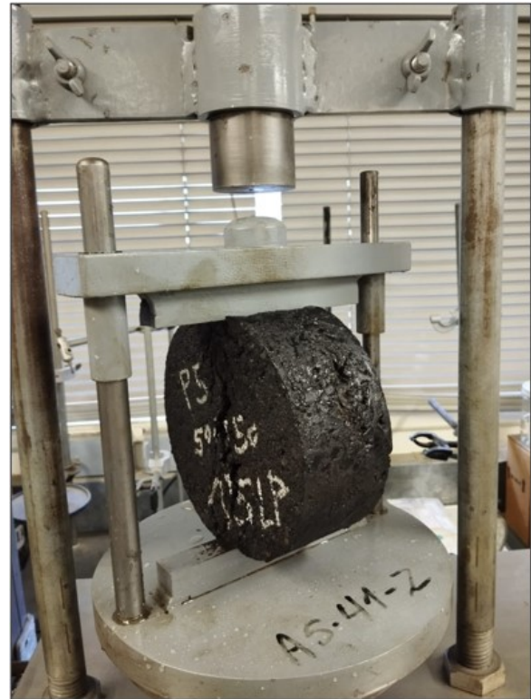
Figura 28: Ensayo de Tracción Indirecta Probeta Ensayada.
