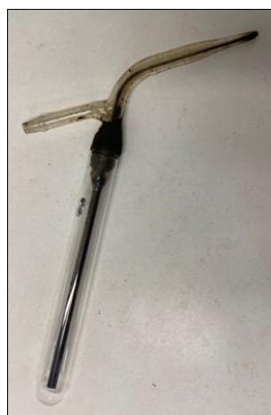
Figura 38: Dosificador Utilizado para la Aplicación del Líquido Piroclítico.
