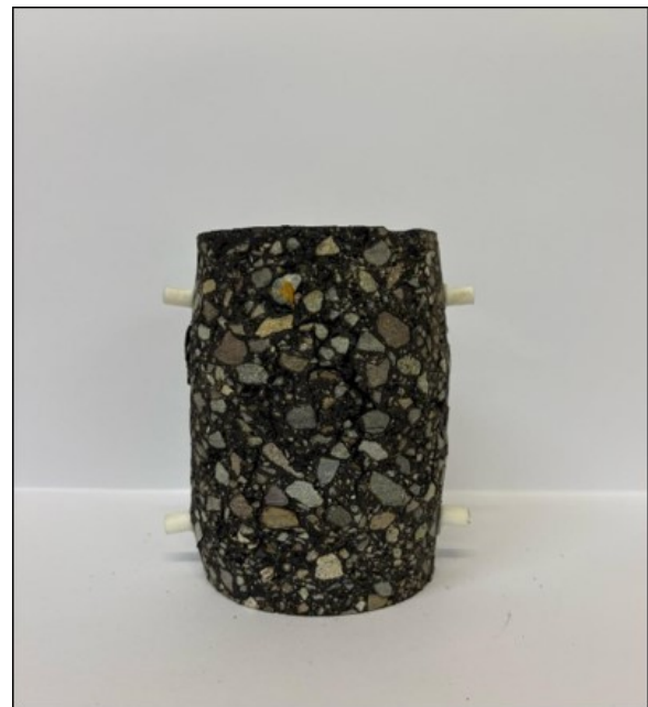
Figura 50: Probeta Posterior a Ensayo de Número de Flujo.
