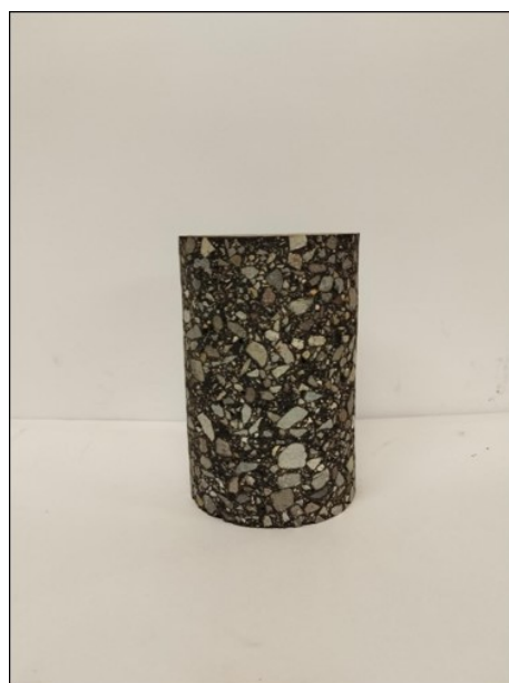
Figura 43: Núcleo de Probeta para Ensayos de Módulo Dinámico y Número de Flujo.
