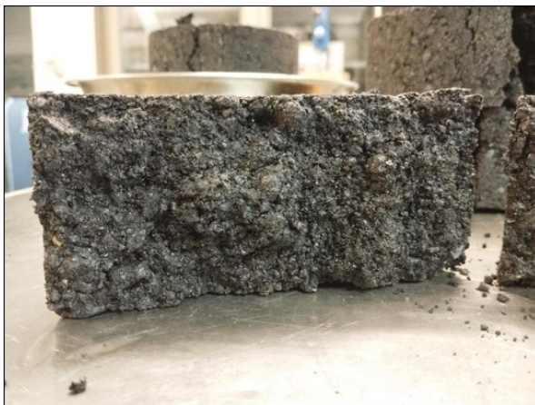
Figura 47: Probeta Ensayo de Tracción Indirecta en Condición No Saturada.
