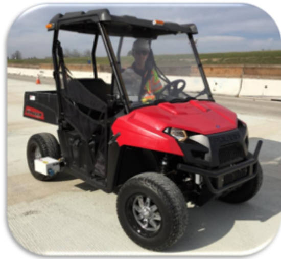
Figura A.2.8: Perfilómetro inercial liviano
