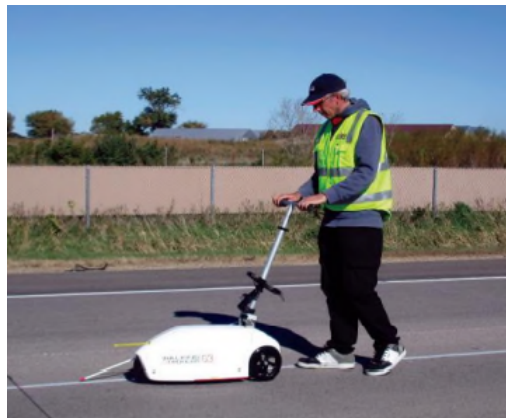
Figura A.2.11: Operación de equipo Walking Profiler
