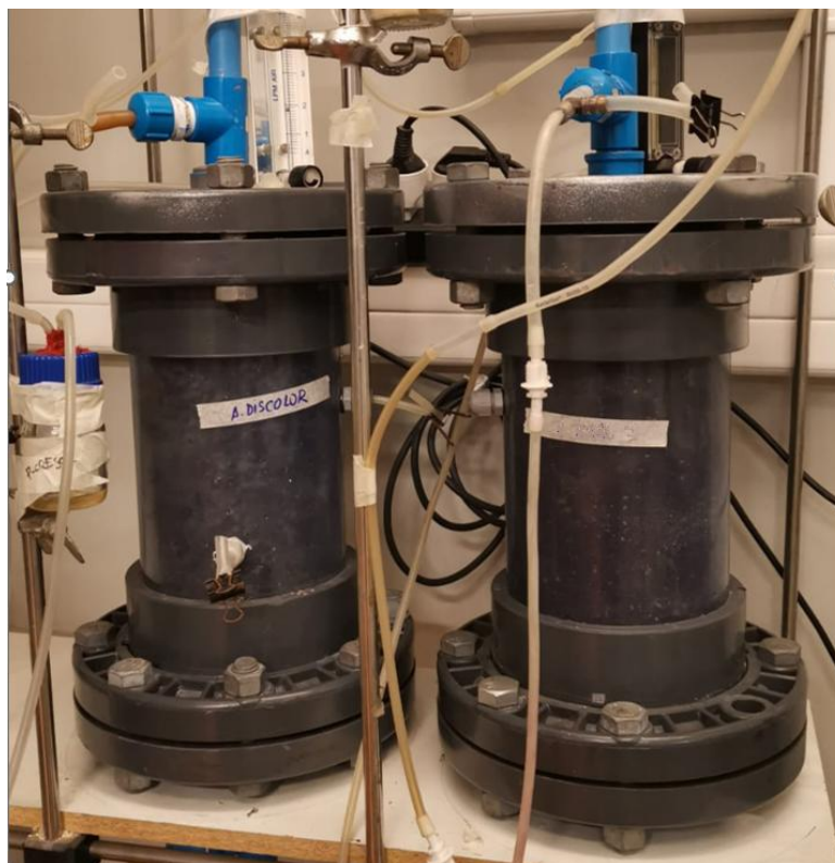
Figura 7-6. Biofiltro de lecho fijo montado en el laboratorio.
