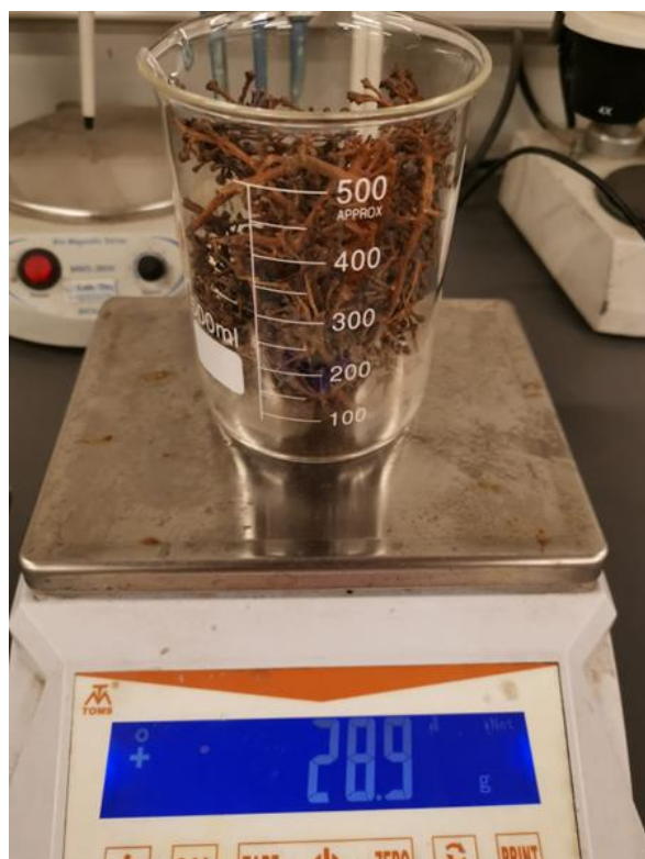
Figura 7-9. Ejemplo de mediciones de masa de racimos de escobajo para determinar la densidad aparente del material.
