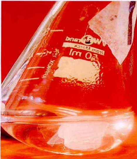
Figura 5: Dispensador de simazina en medio mínimo. Una cabeza de tubo Eppendorf se selló con una membrana de diálisis.
