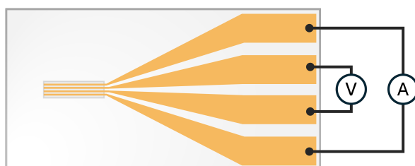
Figura 4.6: Ilustración de sustrato con electrodos de microbanda independientes.
