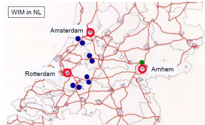
Figura B.7.4: Red de WIM-VID en Países Bajos, se observan las estaciones en construcción (Jacob y Van Loo, 2008)
