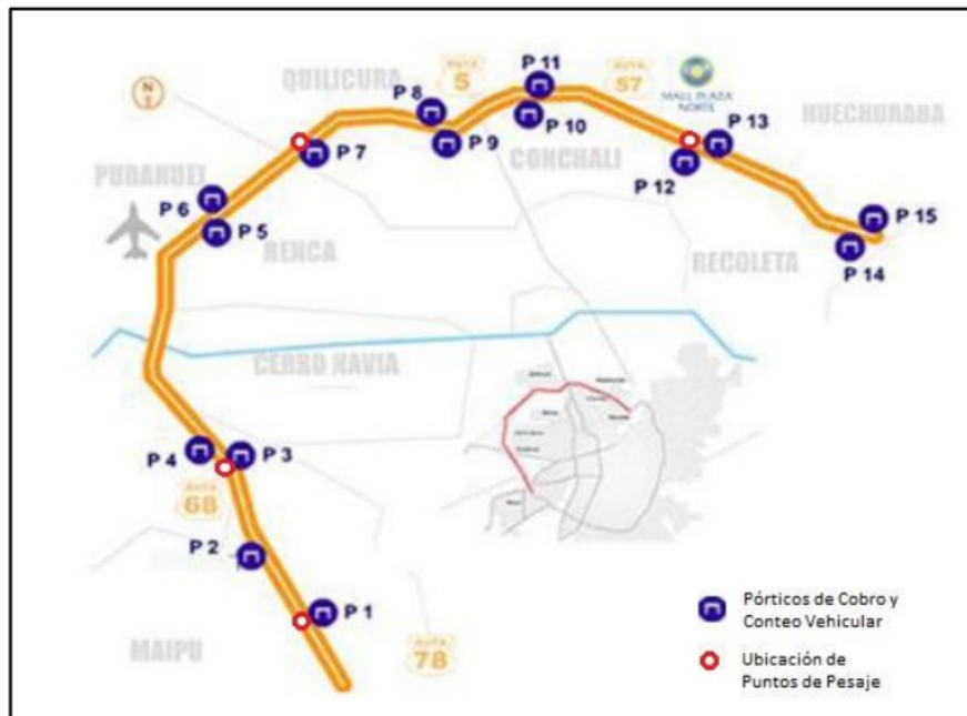
Figura 3-6 Ubicación del Sistema WIM en la Autopista Vespucio Norte
