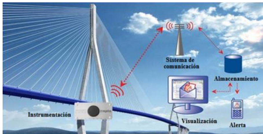
Figura 5.7.1: Esquema de funcionamiento de un SHM (Instituto Mexicano de Transporte).
