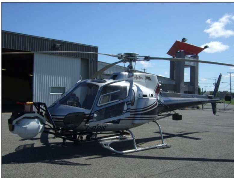
Figura 3.6: Imagen del helicóptero y el soporte que llevan a la cámara, referido como gimbal. Tomado de [2].
