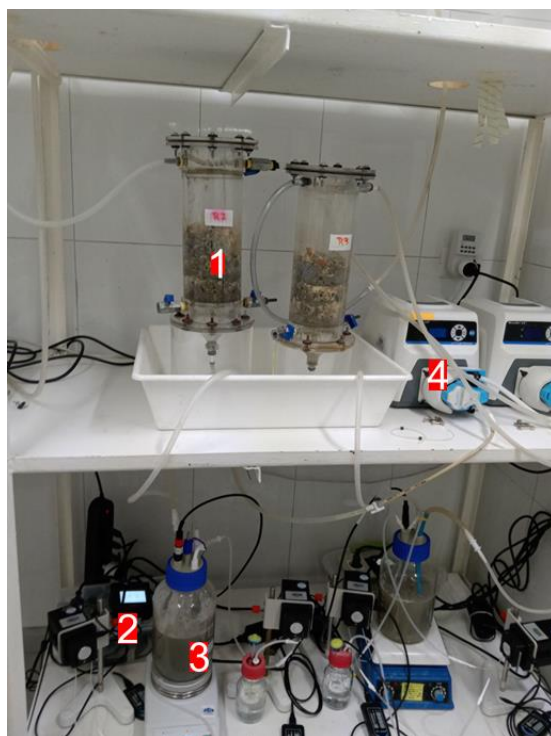
Figura 7. Montaje sistema LBR. (1) LBR, (2) Controlador pH, (3) Estanque lixiviado, (4) Bomba de recirculación.
