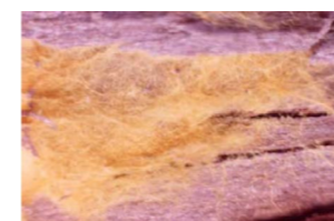
Figura 136 Hifas y micelios 35 de un hongo sobre la superficie de una viga de madera. Fuente: Lasheras, 2009, p. 802.
