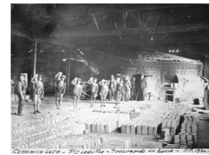
Figura 59 Fotografía de la fabricación de ladrillos (cancha y horno). Fuente: Greve, 1944, p.201.
