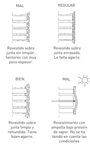
Figura 129 Esquemas en corte que muestran la forma correcta y errónea de la ejecución de los revocos. Fuente: Broto, 2006, p. 151.
