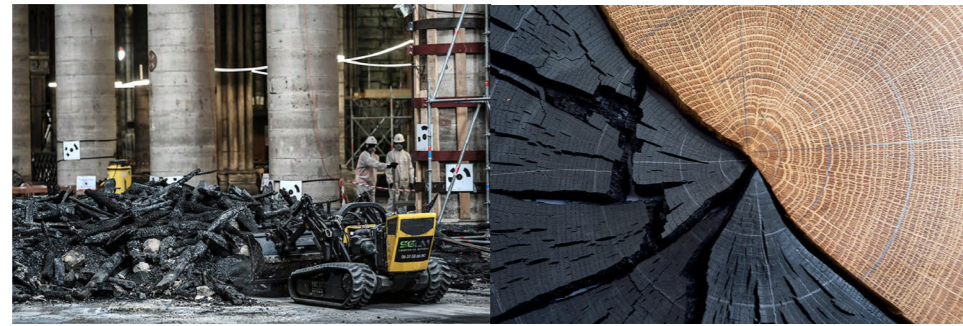
Figura 20. A la izquierda, madera de roble similar a la utilizada en la estructura del techo de Notre-Dame. Parte de este corte fue carbonizado en el laboratorio como modelo para propósitos de comparación. Fuente: Unveiling the Secrets of Notre Dame's Materials, 2019, https://news.cnrs.fr/articles/unveiling-the-secrets-of-notre-dames-materials
