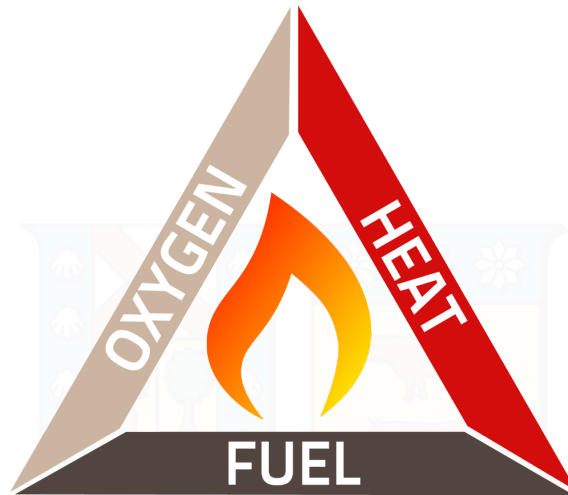
Figura 3.1: Triángulo de requisitos básicos de combustión
