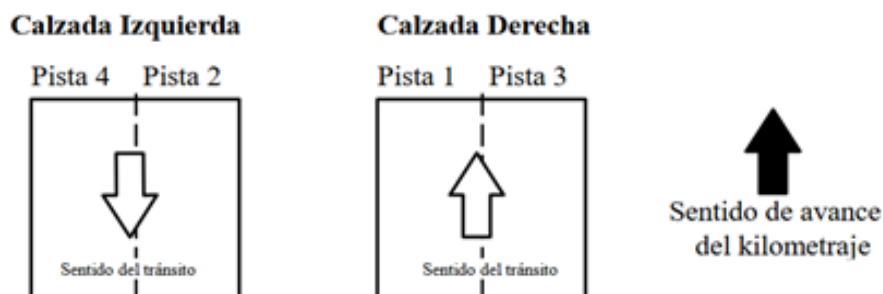
Figura 5.32. Esquema de la enumeración de las pistas en la Ruta III (MOP, 2018).
