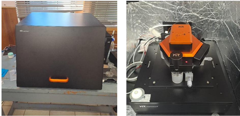
Figura 18 A la izquierda caja acústica para FlexAFM, a la derecha equipo FlexAFM
