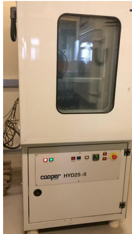
Figura 4-1: Máquina de prueba universal utilizada para el control de temperatura
