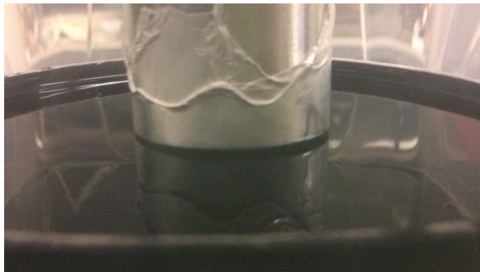
Figura 4-4: Posicionamiento de la superficie del indentador sobre la superficie del ligante asfáltico
