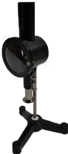
Figura 3.7: Lámpara de Humo estandarizada según la norma ASTM D1322
