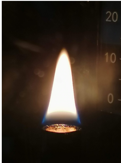
Figura 3.5: Llama de difusión laminar en una Lámpara de Humo Estandarizada.
