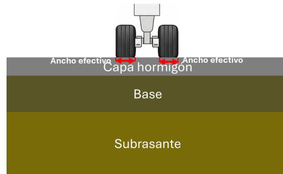
Figura 9. Proyecciones pasadas efectivas en pavimentos de hormigón.
