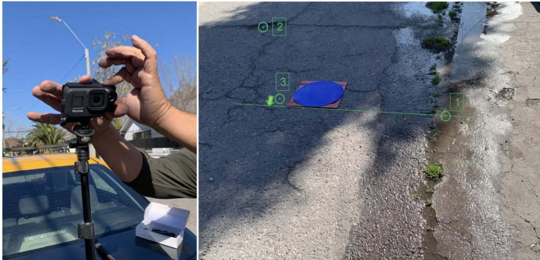
Figura 4.7. La imagen de la izquierda muestra la placa de PLA con un láser apuntando a la misma dirección que el centro del lente de la cámara. La imagen de la derecha muestra cómo se ve el tercer láser en el pavimento.
