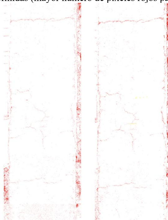
Figura 4.4. Binarización de imágenes de pavimentos deteriorados. La imagen de la izquierda fue grabada con 1920 pixeles, y la de la derecha con 4K.
