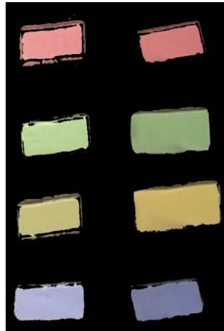
Figura 4.1. Pruebas de detección del color obtenido en Python para distintos pliegos de goma eva. Las figuras de la izquierda son con imágenes obtenidas en resolución 1080 pixeles, y las figuras de la derecha fueron obtenidas con 4K.
