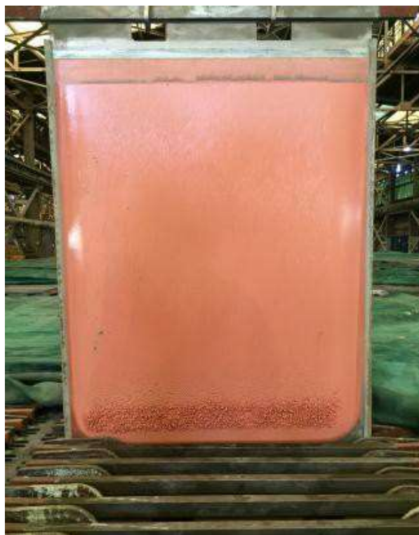
Figura 15 - Nodulación en zona inferior del cátodo.
