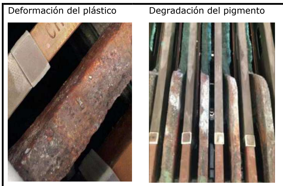
Figura 28 - Clip MAT afectado por la temperatura.
