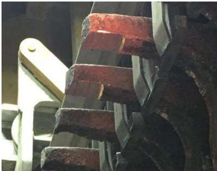
Figura 13 - Orejas frezadas y no frezadas.
