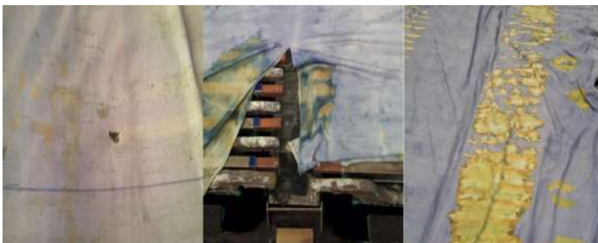
Figura 29 - Telas MAT luego del primer ciclo catódico.
