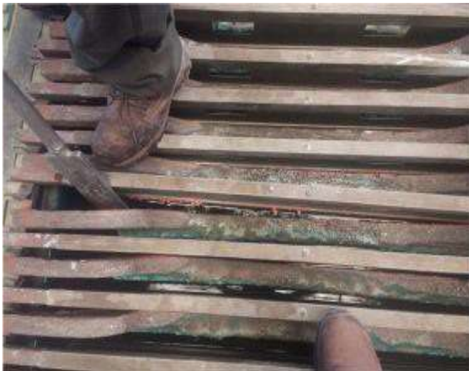
Figura 12 - Ánodos con orejas chuecas en celda.
