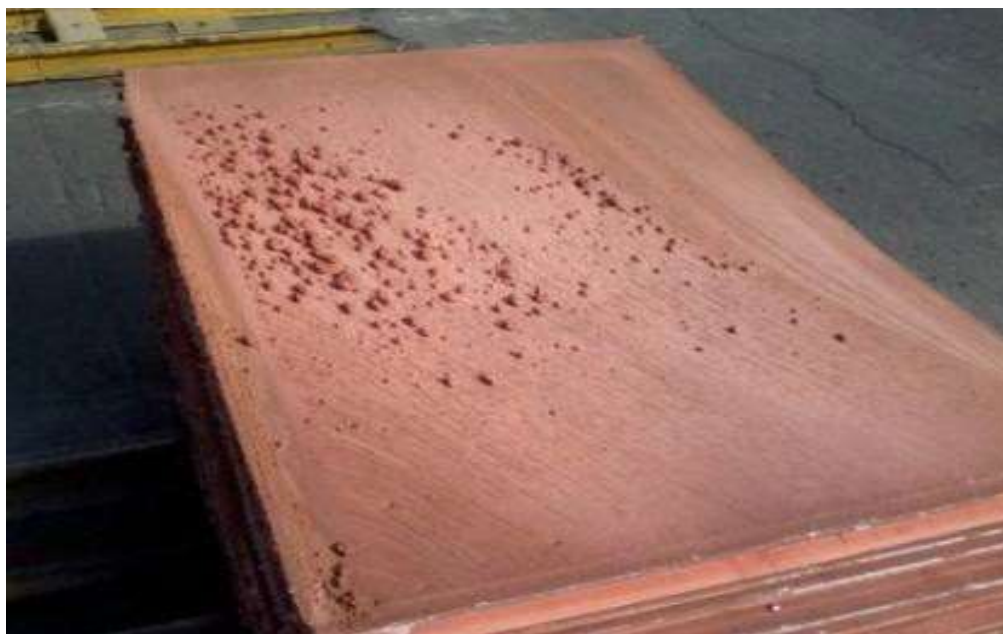
Figura 22 - Cátodo rechazado por nodulación
