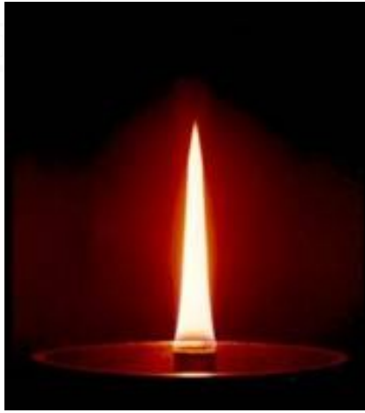
Figura 3.2: Llama de difusión laminar en coflujo en un quemador Gülder. (Fuente: LiiScience.org).
