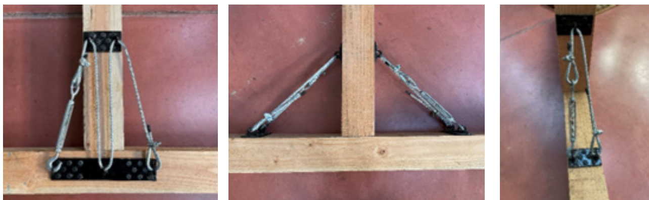
Fig. 142 Prototipado de las soluciones de refuerzo terminadas: (a) "doble placa frontal"; (b) "placa lateral".
