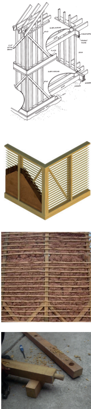
Fig. 7 Sistema constructivo platform frame (Obrien, 2010).
