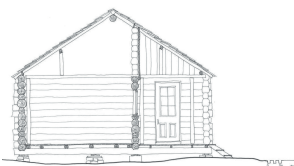
Fig. 3 Sistema constructivo log-cabin construction (Cascajares & Crespo, 2015).
