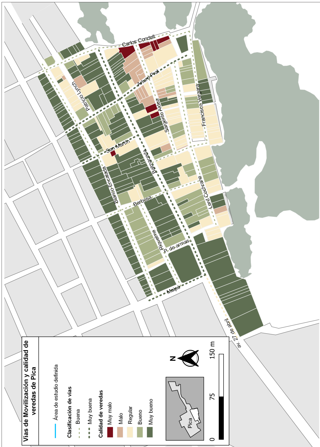
Fig. 36 Mapa con clasificación de vías y calidad de veredas, Pica. Elaboración propia.
