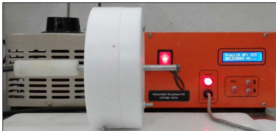
Figura 3.1 Instalación experimental generador de pulsos eléctricos.
