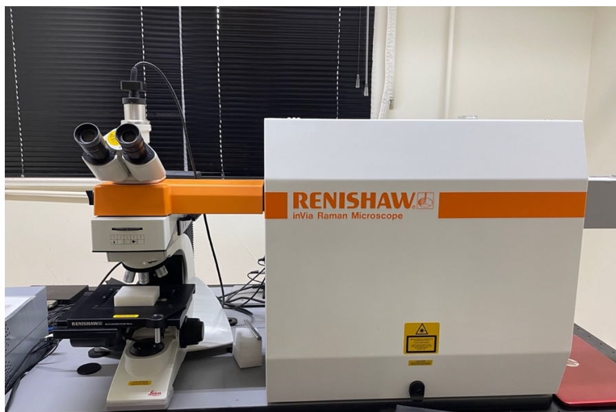
Figura 19. Microscopio Raman utilizado en esta investigación.
