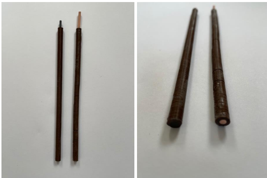
Figura 16. Electrodo de trabajo empleados para pruebas de caracterización electroquímica. (izq.) Electrodo de grafito diámetro 2 mm. (der.) Electrodo de cobre, diámetro 3 mm.
