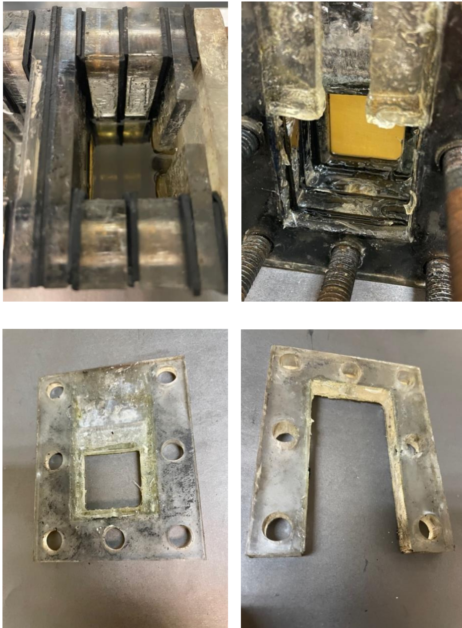
Figura 29. Registros deterioro de unidades modulares de celda de EDR producto de la acción del solvente en compartimiento catódico y utilizar una temperatura de baño termorregulado superior a 50°C.
