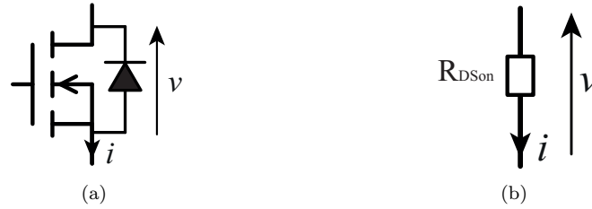
Figura 4.4: Modelo MOSFET conducción (a) Diagrama MOSFET (b) Modelo no ideal MOSFET en conducción
