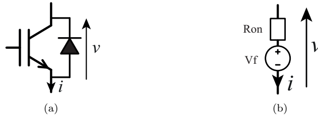
Figura 4.3: Modelo IGBT conducción (a) Diagrama IGBT (b) Modelo no ideal IGBT en conducción
