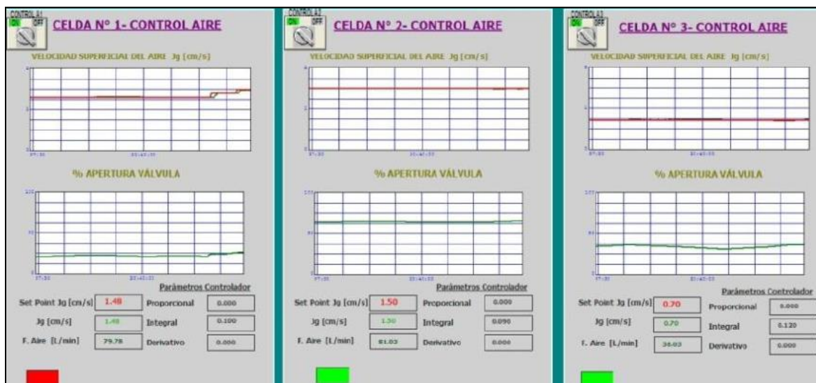
Figura 2.8: Ventana control de aire
