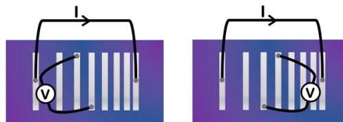
Figura 22: Dos configuraciones de contactos para mediciones de efecto Hall.
