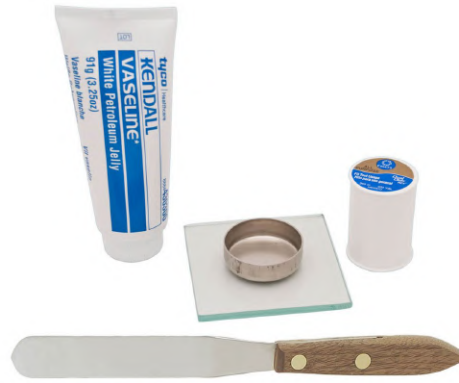
Figura 3.5: Set Utilizado para Determinar el Límite de Contracción Acorde al Procedimiento Descrito en ASTM D 4943 - 02 (Gilson Company Inc.).
