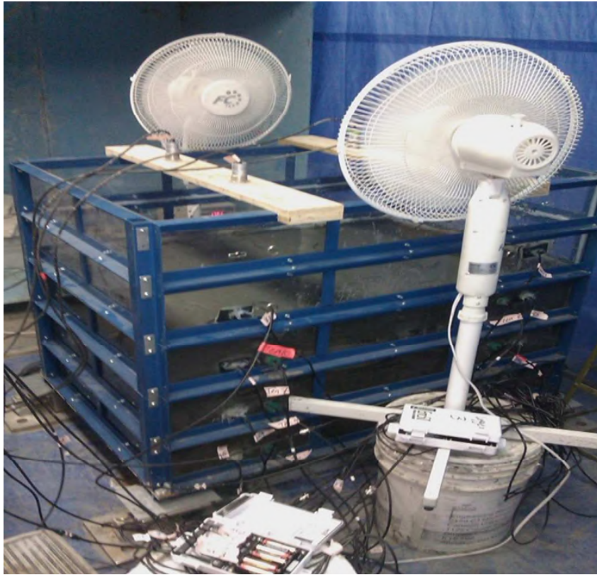
Figura 2.20: Caja de Deseccación Instrumentada Desarrollada por Daliri et al. (2016).
