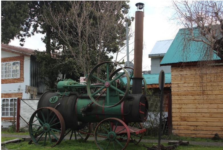
Ilustración 26. Una Locomóvil utilizada en la explotación maderera. Fotografía, Gabriela Sanzana, 2018.
