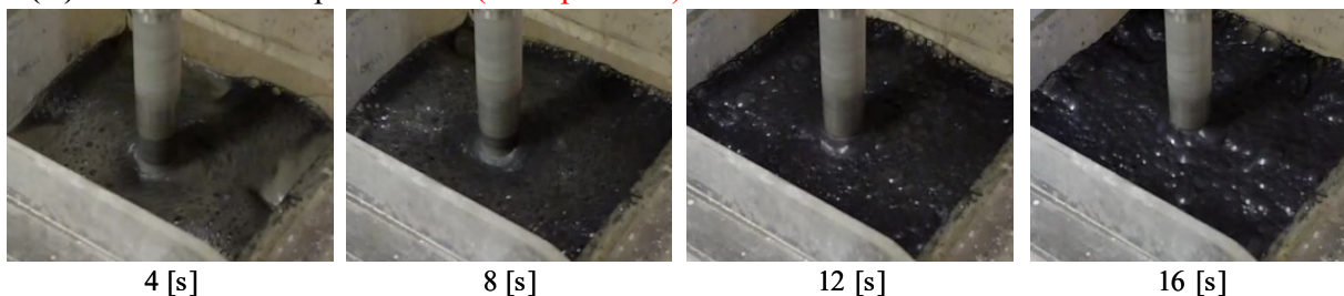
Figura 6.6: Comparación de espumas generadas al emplear microesferas de vidrio sin hidrofobizar y espumante (A) y al emplear sólo MVHH en ausencia de espumante (B).
