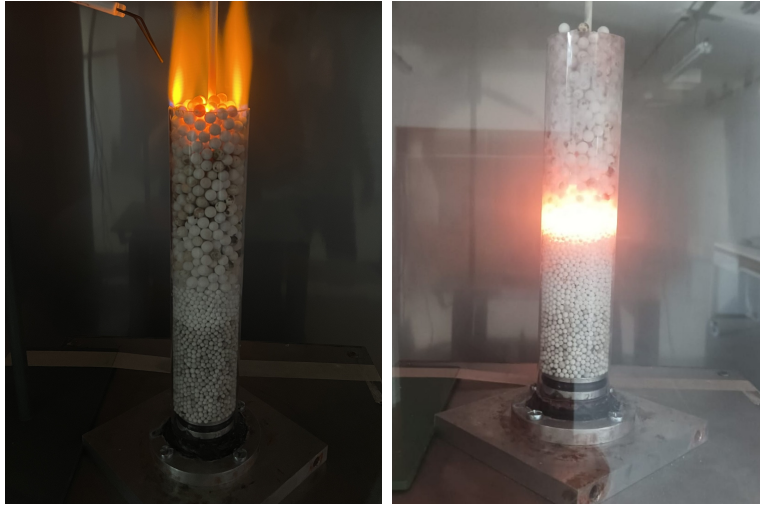
Figura 1.1: Reactor MPI con llama libre (izq.) y llama sumergida (der.)
