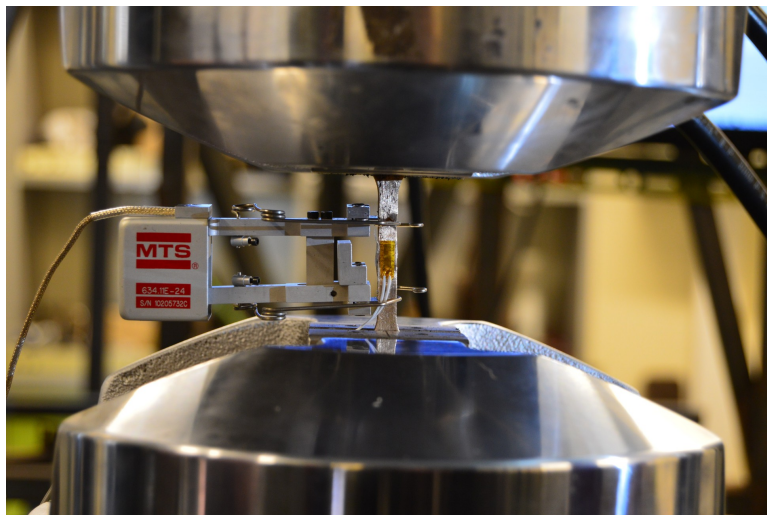
Figura 4.3: Montaje experimental utilizado para los ensayos en máquina universal MTS 810, equipada con mordazas hidráulicas y extensómetro axial.
