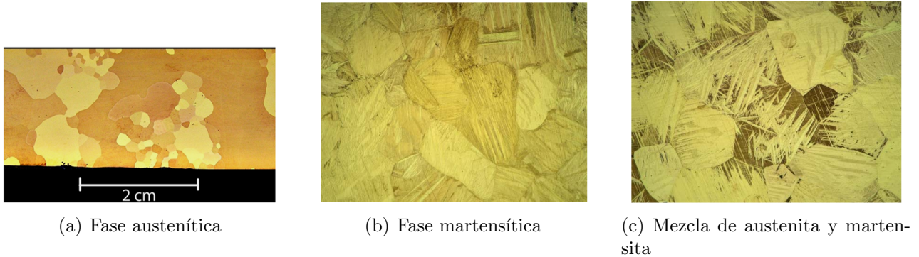
Figura 4.1: Microestructuras representativas de las fases observadas en la aleación CuAlBe: (a) fase austenítica, (b) fase martensítica y (c) coexistencia de ambas fases. Las imágenes fueron proporcionadas por la UNAM durante la caracterización del material.
