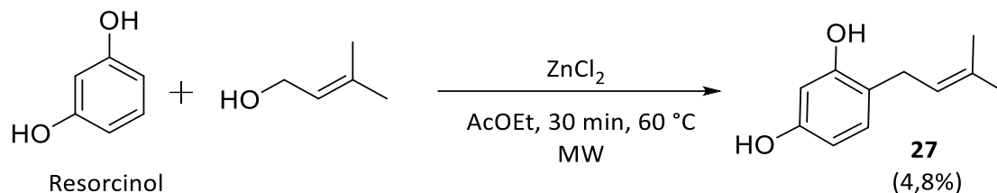
Esquema 9: Reacción de acoplamiento entre el resorcinol y prenol en presencia de un ácido de Lewis como catalizador.
