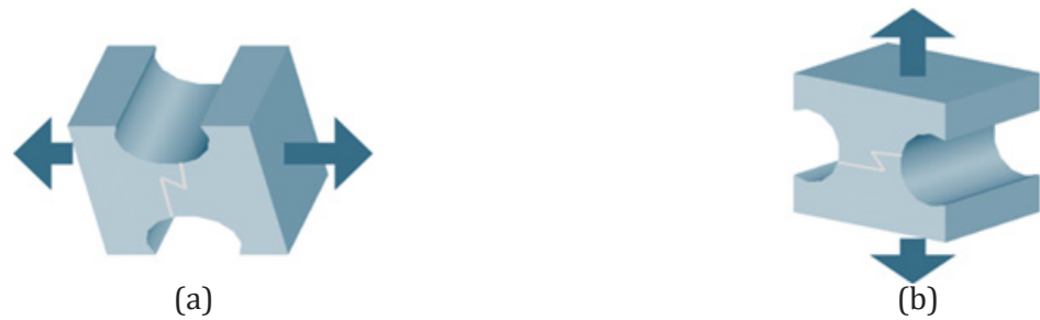
Figura 13 Ensayos de tracción (a) paralela a las fibras y (b) perpendicular a las fibras.
