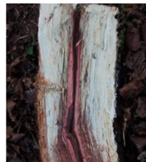
Figura 24 Daños producidos en la madera por hongos de pudrición blanca (Maderame, 2020).
