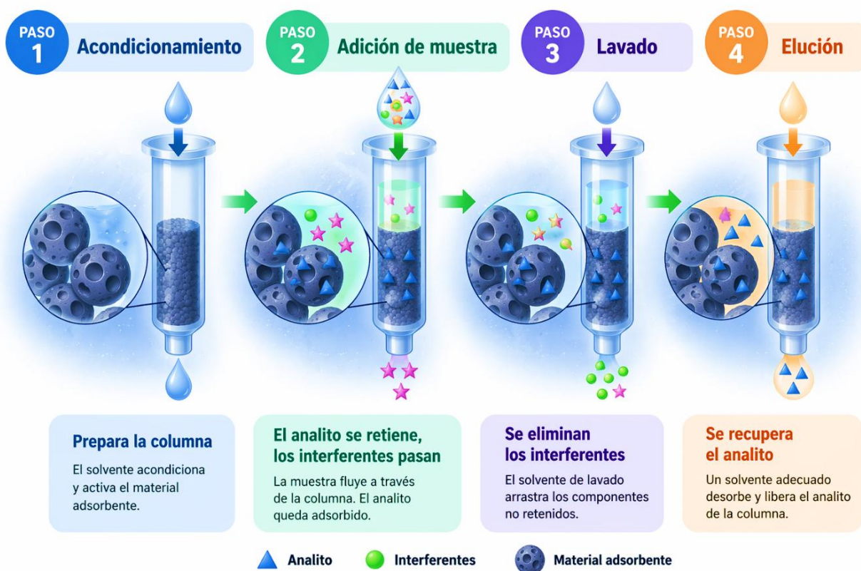
Figura 4: Pasos del proceso de extracción y preconcentración en cartuchos de SPE.
