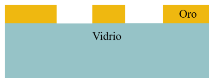
Figura 57 : Paso 1: Despósito de 20 nm de oro sobre el vidrio con PMMA estructurado con el molde de DVD. Paso 2: Con acetona se remueve el PMMA para que quede el vidrio con el depósito de oro.
