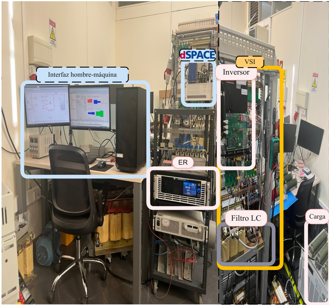
Figura 2.3: Configuración experimental para el MPC en un inversor fuente de voltaje.
