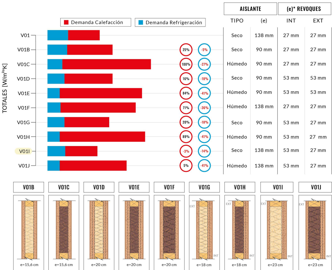
Fig. 22 Resumen gráfico demanda energética anual variantes de quincha estudiadas, según espesor de aislante y revoques.
