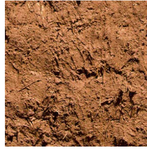
Fig. 17 Detalle revoque grueso elaborado con tierra cruda (proporción 1:1 de tierra arcillosa y arena gruesa, más el 15% volumen con paja de trigo picada). ©Sebastián Astroza
