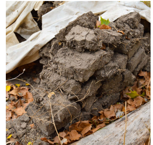
Fig. 35 Adobes recogidos de vivienda en proceso de rehabilitación.
