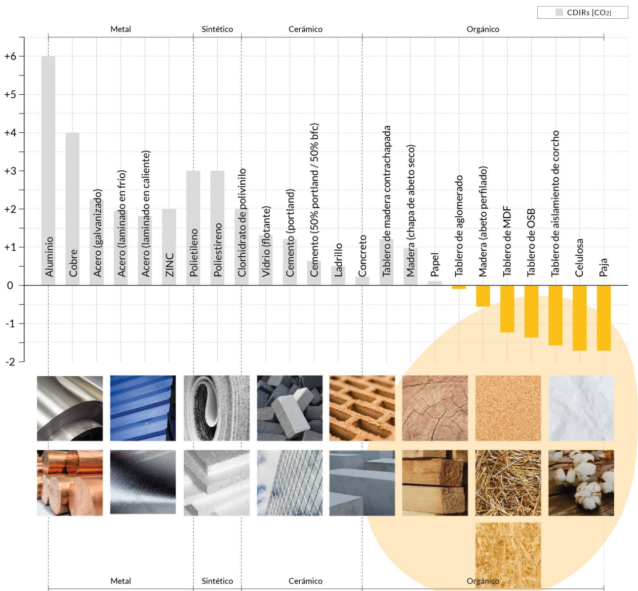
Fig. 6 Relaciones de intensidad de dióxido de carbono (CDIR) por peso para 24 materiales de construcción comunes.
