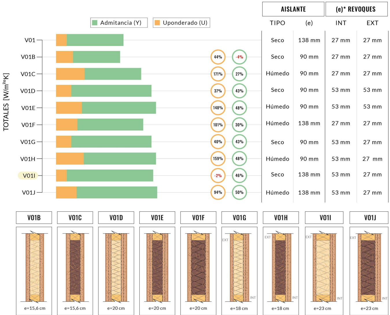
Fig. 19 Resumen gráfico resultados obtenidos para transmitancia y admitancia térmica de las soluciones de variantes de quincha estudiadas según espesor de aislante y revocos.
