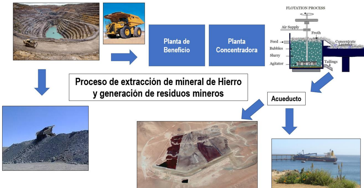
Figura 4-2 - Resumen de proceso de generación de residuos mineros y extracción de mineral de hierro
