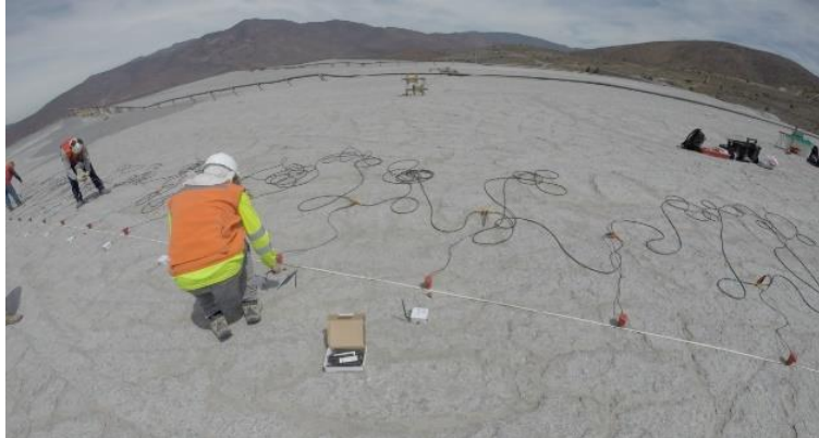
Figura 5-21 - Equipo MASW. Fuente: elaboración propia.
