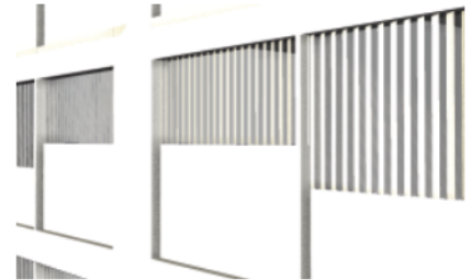
Parasoles de tipo vertical, eficientes para las orientaciones Este-Oeste. El programa CEV admite sólo parasoles fijos.
