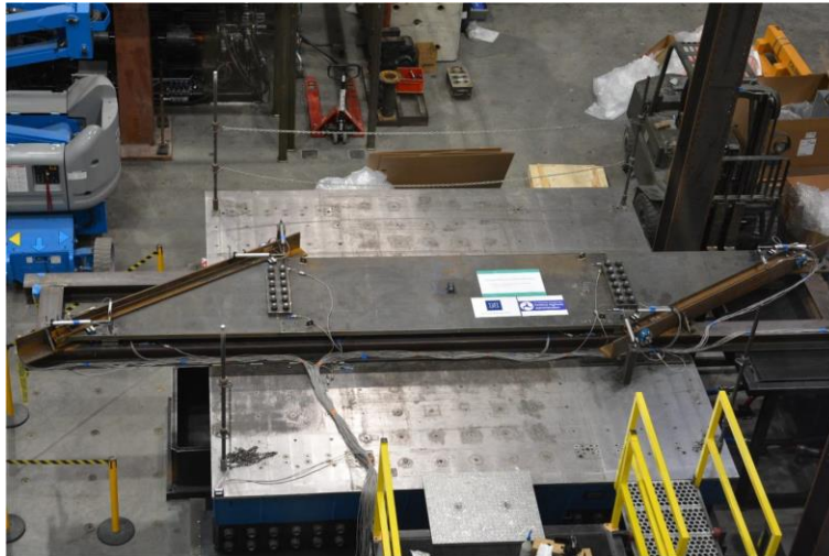
Figura 2-19 - Puente modelo con esviaje = 60 [°] [8]
