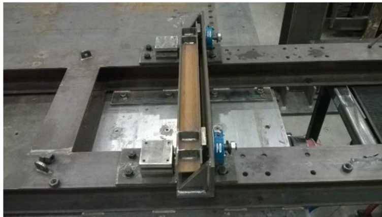
Figura 2-20 - Estribo de puente modelo con esviaje = 0 [°]
