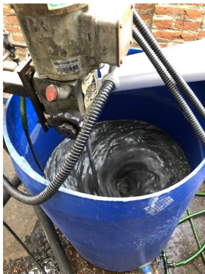
Figura 5.1. Agitación de la pulpa a alta velocidad para activación.
