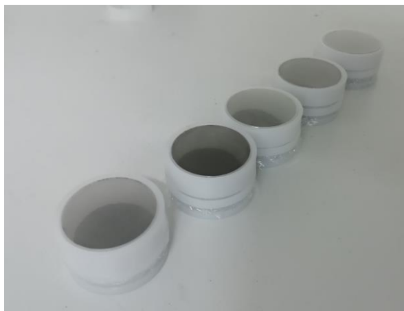
Figura 5.5. Muestras tomadas secas, en contenedores para análisis por XRF.
