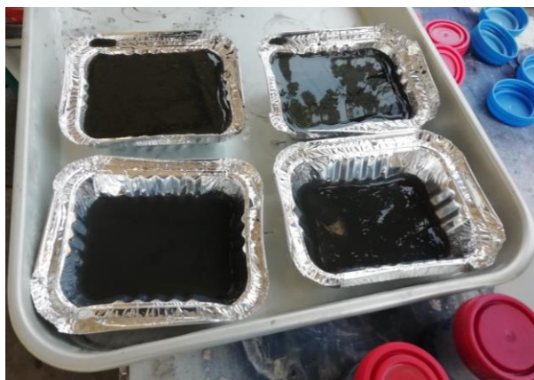
Figura 5.4. Muestras tomadas a contenedores de aluminio, previo a secado.
