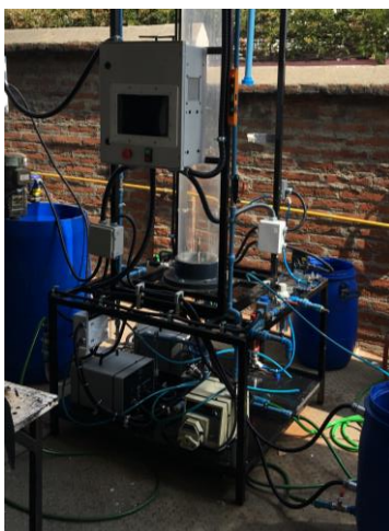
Figura 3.1. Fotografía columna de flotación experimental.
