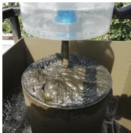
Figura 5.3. Espuma en tope de columna en operación con pulpa de cobre.
