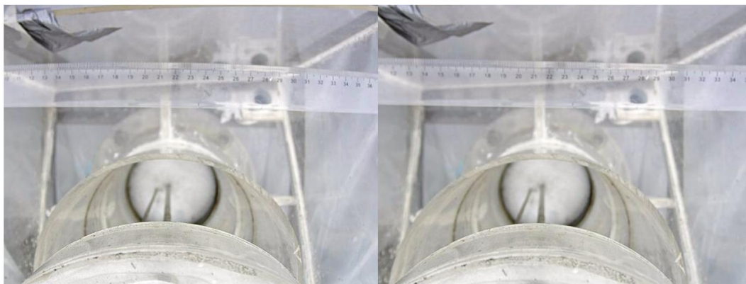
Figura 4.2. Corrección de efecto de lente curvo en cámara IP.
