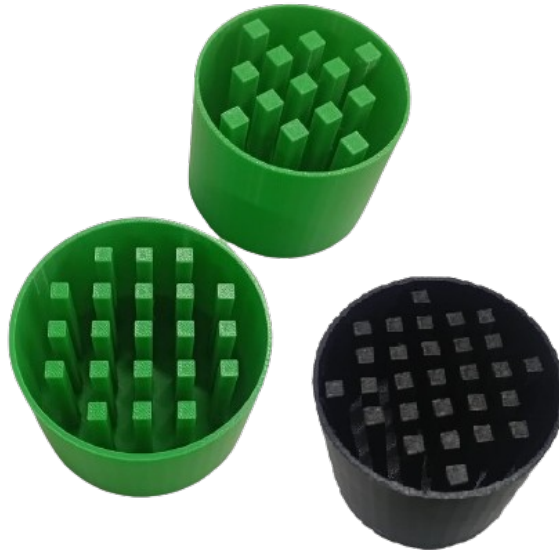
Figura 5.1: Moldes impresos en 3D utilizados para la fabricación de pellets monolíticos con distintas configuraciones geométricas (desde arriba hacia abajo, diseño 1, 2 y 3).
