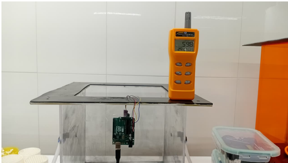
Figura 5.6: Sensor PCE-7755 utilizado para la calibración del sensor SCD30
