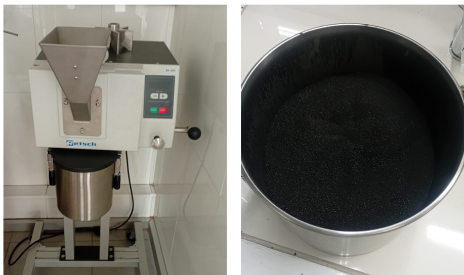
Figura 5.7: Polvo molido con motor de impacto de rotor SR 300 RETSH, el polvo presenta un tamaño de partícula menor a 500\ \mu\text{m}
