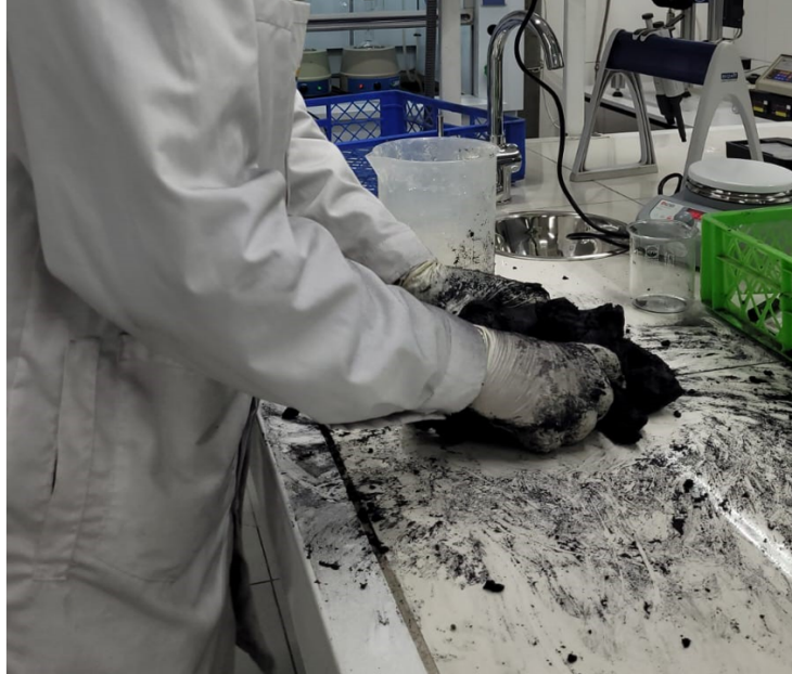
Figura 5.9: Masado de manera manual durante 30-35 min hasta lograr una consistencia homogénea de la pasta.
