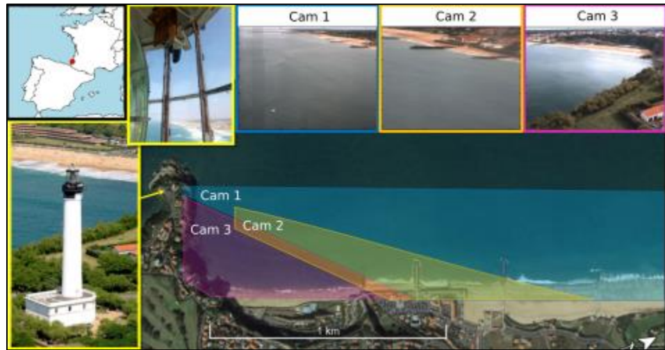
Figura 4: Utilización de videos remotos y fotografías en playas para determinar líneas de costa.
