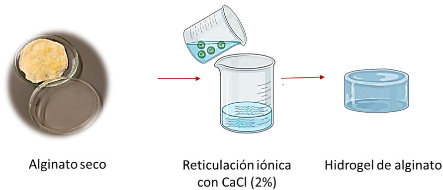
Figura 5.1 Esquema representativo de formación de hidrogeles de alginato con reticulación iónica.
