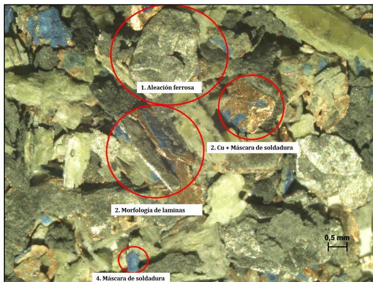
Fig. 4.2 NC-WPCB +425 \mu\text{m} a -2 mm utilizando ZEISS Stemi 2000-C (MO) a 6.5X.
