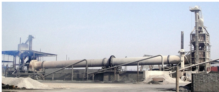
Figura 3.1: Horno rotatorio en la industria de la minería. Fuente: [3]
